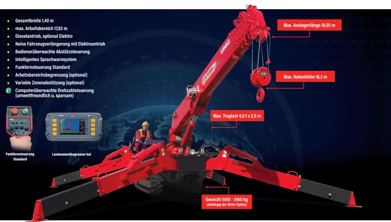
Der URW-547 erreicht im Standard mit seinem langen Ausleger eine maximale Hubhöhe von 18,2 m und eine maximale Tragkraft von 4,0 t. Der URW-547 hat die gleichen kompakten Abmessungen und
