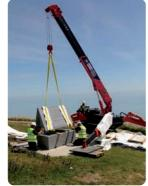
die gleiche Abstützbasis wie das Modell URW-546. Eine Verlängerung des Auslegers wird mittels des schnell angebauten 0,80 m Hilfsauslegers erreicht, Abwinklung 0°, 20°, 40° und 60°, max. 500 kg Tragkraft.
